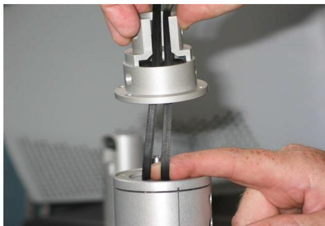
Imagen 8. Correa entre rodillos y pared del tensor
