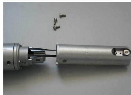
Imagen 3. Desmontaje vástago de la DRT
